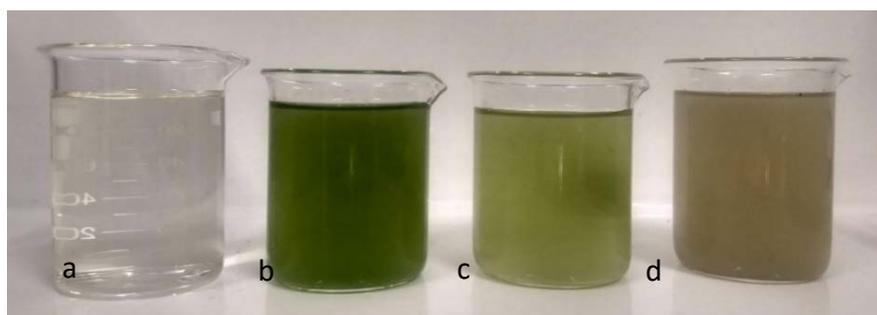
**Figura 5.** Aspecto visual das amostras coletadas. a) permeado; b) concentrado da retrolavagem; c) efluente secundário; d) e esgoto bruto.
